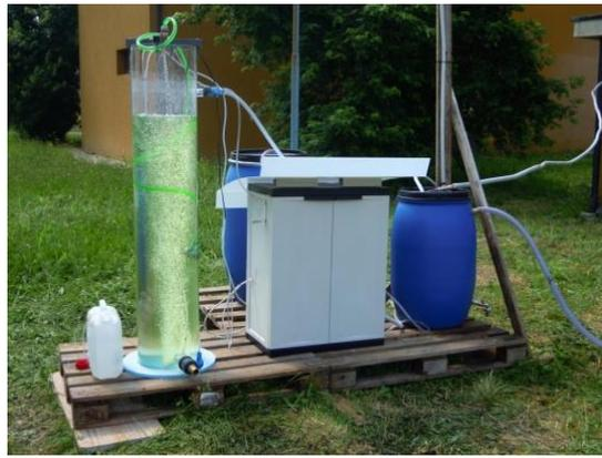
**Figura 3:** Colonna di coltivazione di microalghe sul separato liquido presso un impianto di depurazione
