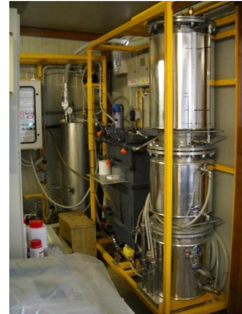
**Avviamento dell'impianto utilizzando biomassa granulare ANAMMOX preformata (impianto di Rotterdam – Dr. Lotti)**
